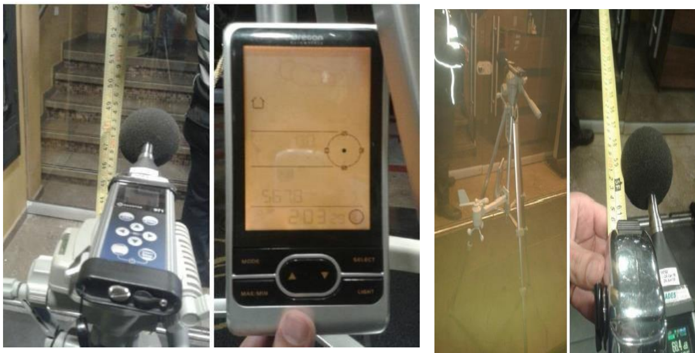
Medición de niveles de emisión de ruido
